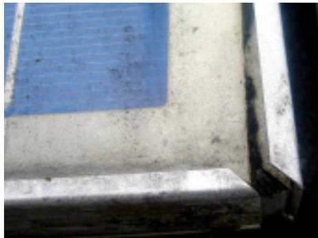
**Bei diesem Modul reduziert nicht nur die Verschmutzung dessen Leistung: Durch den defekten Modulrahmen ist das laminierte Modul offen und Feuchtigkeit dringt in die Solarzellen ein.**
